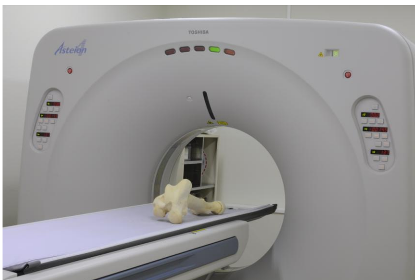
図1:キリンの大腿骨をCTスキャンに入れる。瞬時に骨の内部構造が観察できる。
